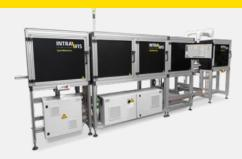
单独完成检查。SpotWatcher\*定制是可定制的瓶子和容器检测解决方案。多达15台高分辨率摄像机和20多种可选测试选项,确保您不会接触到任何不良产品。
