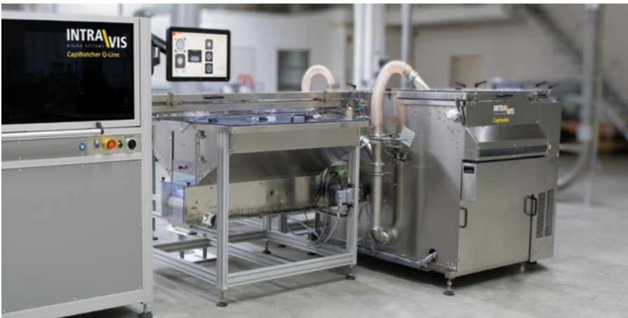
Eine von verschiedenen Layout-Varianten für Verschlusszuführung & -inspektion
