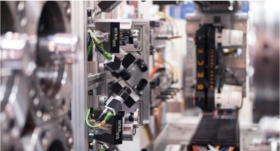
Inspektionssystem speziell für die Qualitätssicherung von In-Mold-Etiketten
