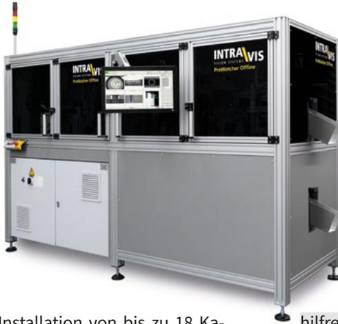
und der Installation von bis zu 18 Kameras ist der PreWatcher Offline ideal geeignet für eine schnelle und umfassende Prüfung wichtiger Qualitätsmerkmale. Ganz gleich, ob Ihre Preforms transparent oder opak, groß oder klein sind - das System garantiert volle Produktsicherheit.
