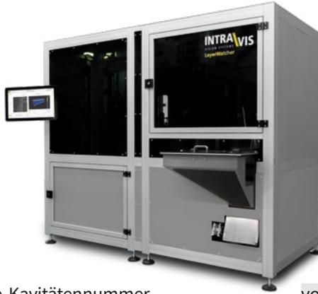
ben und durch ihre Kavitätennummer identifiziert. In etwa 45 Sekunden prüft der LayerWatcher das Barrierematerial. Anschließend werden die Ergebnisse in einer Visualisierung der einzelnen Schichten und einem umfassenden 3D-Gesamtbild des Preforms dargestellt.
