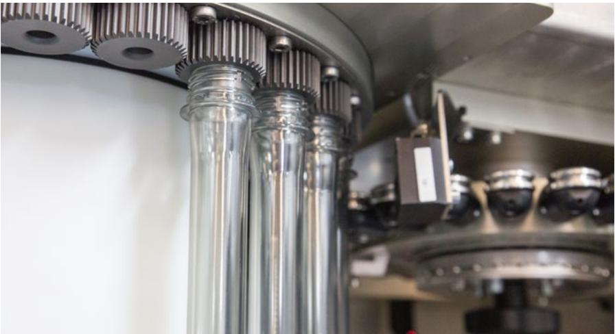
Dank einer ausgeklügelten Mechanik, werden die Preforms 360° vor den Kameras präsentiert und so vollumfänglich und detailliert geprüft
