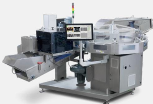
**Компактное, 3-в-1, решение для проверки преформ.** Подача, ориентация и проверка преформ: с помощью PreWatcher® Inline Вы получаете компактное решение 3 в 1 для проверки. Встраиваемая сразу после литьевой машины система, где преформы аккуратно загружаются, ориентируются и проверяются. Дефектные изделия выбраковываются сразу. Кроме того, Вы получите информацию о производственном процессе.
