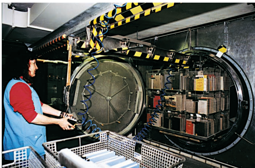
Abb. 2: Massenentsäuerungsanlage für die Behandlung gefährdeter, sauer gefertigter Papiere mit noch ausreichender mechanischer Festigkeit. Entsäuerungsreagenz: Magnesium-Titanalkoxid in Hexamethyldisiloxan. Inbetriebnahme 1994, Kapazität: 100 t / Jahr
