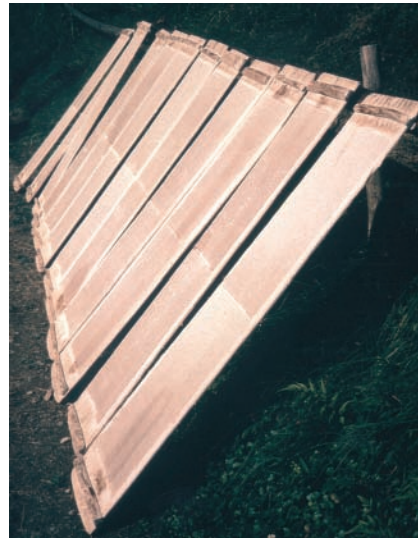
Abb. 1: Die geschöpften Blätter werden noch feucht auf Holzbretter gestrichen und in der Sonne getrocknet.
