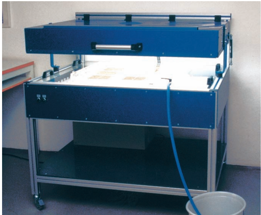
Abb. 4: Die im Rahmen einer Diplomarbeit entstandene Lichtbleichanlage
