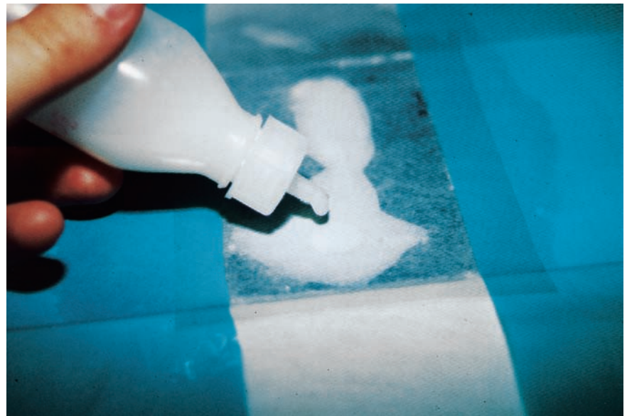
Abb. 2: Die Fasersuspension aus kollagenen Fasern wird in eine Schablone in Form der zu ergänzenden Fehlstelle getropft. Die Schablone liegt auf einem Stützmaterial aus Polyester. Durch Sog wird das Wasser entzogen, ein dichtes Faservlies bildet sich.
