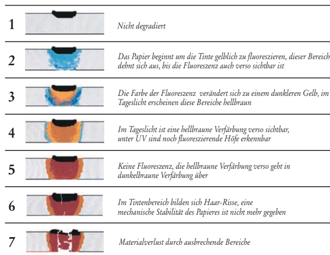
Abb. 2: Schematisches Modell zum Schadensverlauf von Tintenfraß
