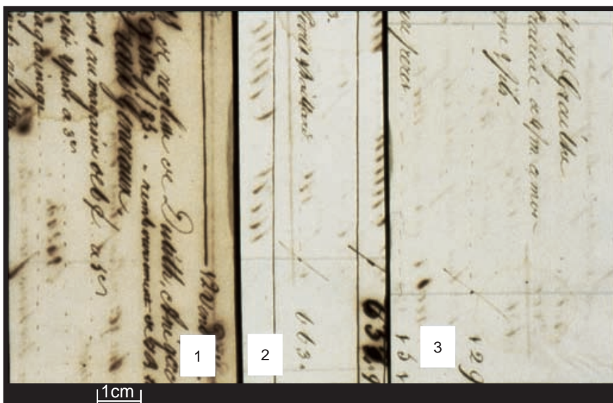
Abb. 5: Manuskript des 18. Jh. (Versuchsobjekt, Hadernpapier) nach künstlicher Alterung. 1: unbehandelt 2: nach einer wässrigen Entsäuerungsbehandlung mit Calciumbicarbonat 3: nach Entsäuerungsbehandlung und zusätzlicher Leimung mit Gelatine. Die Tinte ist weniger stark durchgeschlagen. Tintenfraß wurde gehemmt.
