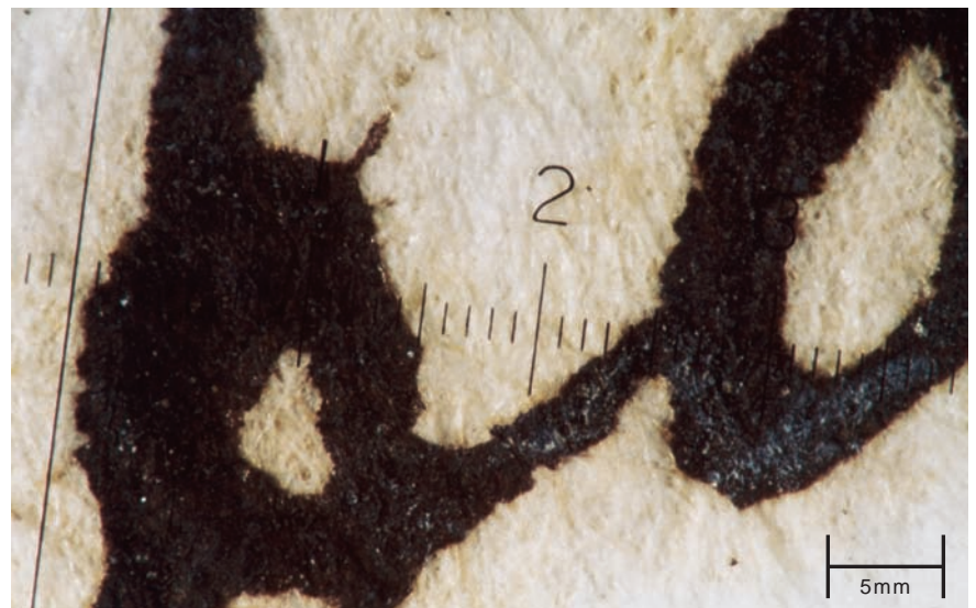
Abb. 5: Ablagerung von weißen Kristallen auf der Tintenoberfläche nach einer Phytatbehandlung
