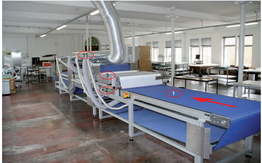
Abb. 7c: Kartenreinigungsanlage Gothana. 1) Laufband, Vorlauf, 2) Ansaugeneinheit 1, 3) Reinigungsmodul 1, 11) Absaugsystem.
