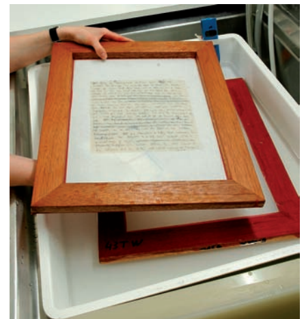
Abb. 9: b) Die straffe Siebbespannung sorgt für eine plane Auflage des flexiblen Behandlungssandwichs während des Abziehens der überschüssigen Flüssigkeit.
