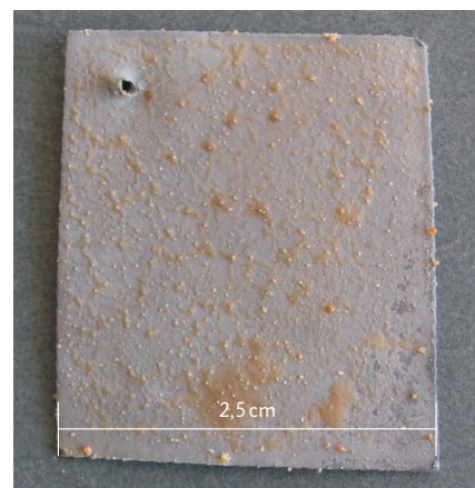
Abb. 3: Korrosion an Bleiplättchen verursacht durch Ausgasung von Essigsäure aus Sperrholzspänen.
