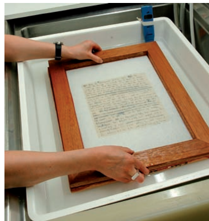
Abb. 8: Der Waschprozess bzw. das Einspülen der Behandlungssubstanzen in das Behandlungssandwich wird durch leichtes Heben und Senken des oberen Siebrahmes beschleunigt.
