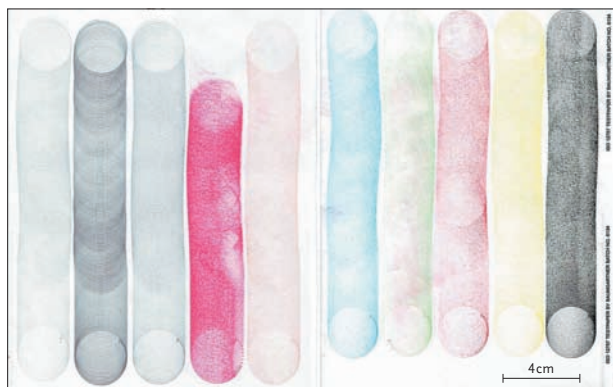
Abb. 9: Testblatt, entwickelt mit der Firma Stabilo International, Heroldsberg. Farbaufträge von links nach rechts: Bleistifte der Stärken H, HB und B der Marke Stabilo, Pastellstift Carbothello rot der Marke Stabilo, Farbstifte FA5 blau, grün, rot, gelb und schwarz der Marke Stabilo.
