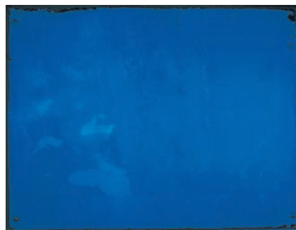
Abb. 3: Intensive Fluoreszenzerscheinungen im UV-Licht (Rückseite des Objektes) als Folge lokaler oxidativer Veränderungen der Cellulose; Aufnahme während der Restaurierung.
