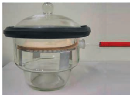
Abb. 1: Versuchsaufbau für künstliche Alterungsexperimente und Probenahme mit SPME. Glasexsikkator mit Probengut und Schleuse für SPME-Faserhalter.
