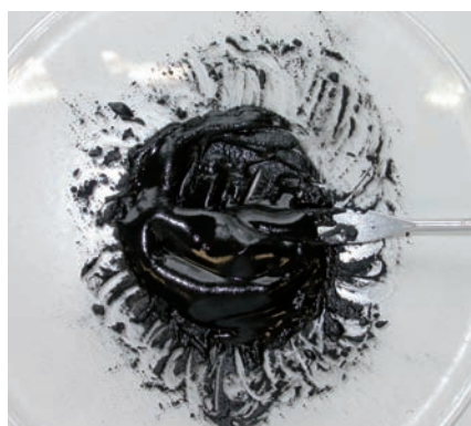
Abb. 4: Vermischen des Sepia-Pigments mit einem Teil der Kaliumhydroxid-Lösung.
