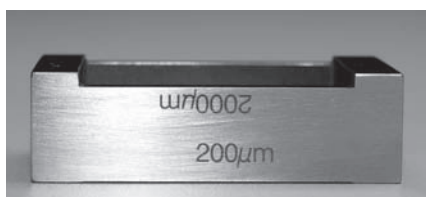
Abb.2.: Filmziehgerät für einen glatten und gleichmäßigen Gelatinauftrag.
