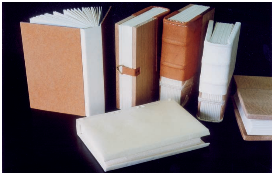
Abb. 1: Verschiedene Konservierungseinbände: von links nach rechts: Viertelfalz-Einband nach Szirmai; 3 Holzdeckel-Konservierungseinbände; vorne: flexibler Pergamenteinband nach Christopher Clarkson.
