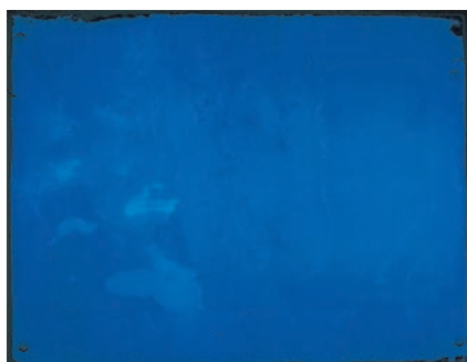
Obr. 2: Detail nápadně zbarvené skvrny způsobené oxidativními změnami v celulóze při vztlínání vlhkosti.
