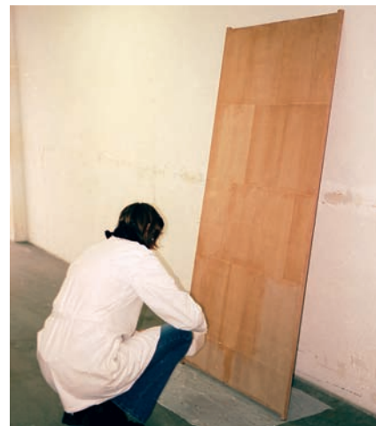
Abb. 11: Fertigstellung des Karibari-Trocknungspaneel nach dreifachem Kakisaft-Auftrag.
