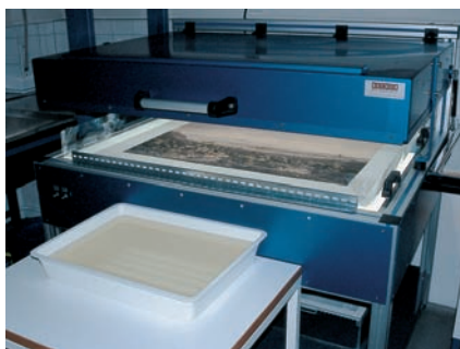
Abb. 7: Die Lithographie während des Lichtbleichverfahrens. In der kleinen Wanne ist eine deutliche Verfärbung der Calciumhydroxidlösung nach der Behandlung zu beobachten.
