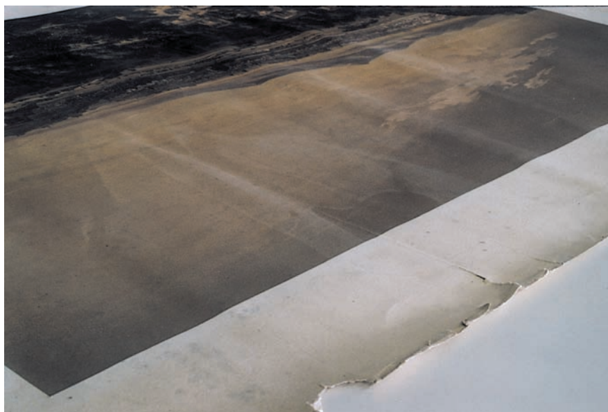
Abb. 5: Weiße kristalline Ablagerungen besonders im Bereich der Papierverwellungen und der Wasserschäden als Folge der Badbehandlung mit einer konzentrierten Magnesium- / Calciumhydrogencarbonatlösung.
