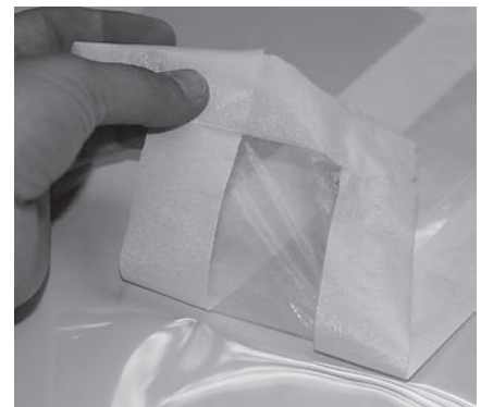
Abb. 7: Schritt 6: Nach der Trocknung – nach ca. 1–1,5 Stunden – wird das beschichtete Berlin-Tissue mit Hilfe des Abdeckklebendes von der Melinexfolie abgezogen und kann sofort für Stabilisierungsarbeiten eingesetzt werden.
