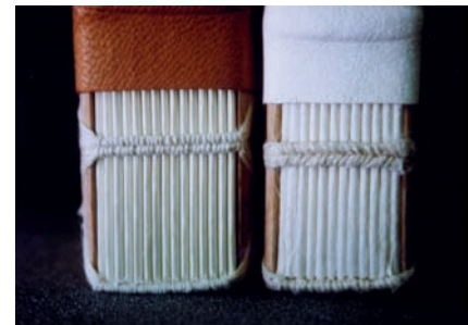
Abb. 12: Heftung. links: Rundbogenheftung, rechts: Fischgrätheftung mit Leporellofalz.
