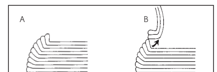
Abb. 8: Die eingeklemmten Außenlagen (A) müssen erst befreit werden, bevor der Rücken (B) sich aus der Rundung hervorheben kann (nach Gurbat 1929).
