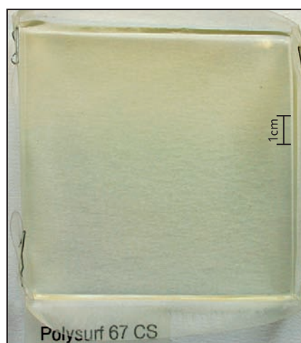
Abb. 2: Polysurf 67 CS, 7% in einer Schablone aus Polyesterfolie ausgegossen, nach 24 Stunden Quellzeit.
