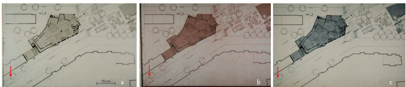
Abb. 4: Berlin-Schöneberg, Viktoria-Luise-Platz, Kirche der Verklärung Christi, Entwurf (1966), Hans-Scharoun-Archiv WV 234/6, /5 und /7, Lageplan, 84 × 153 cm, Ausschnitte. Von der Zeichnung in Bleistift und Tusche auf Transparentpapier (a) wurde eine Transparent-Lichtpause angefertigt (b). Von der überarbeiteten Transparent-Lichtpause wurde eine opake Lichtpause hergestellt (c). Die Pfeile in Abb. 4a–c markieren die Positionen der Details in Abb. 5a–c.
