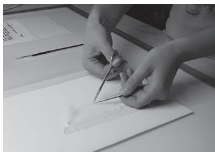
Abb. 9: Zuschneiden des gelatinebeschichteten Berlin-Tissue
