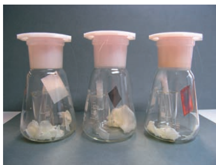
Abb. 2: In Probengefäße eingehängte Indikatormetalle.
