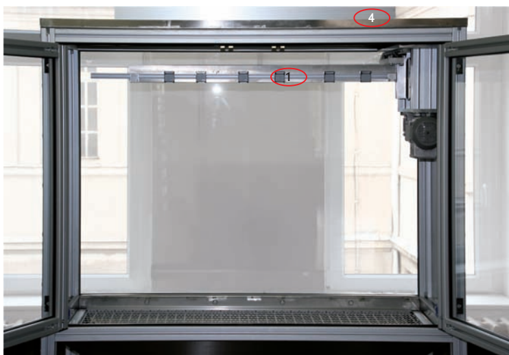
Abb. 20: Messkammer. 1) Halteschiene Karten, 4) Feinstfilter Ansaugluft.
