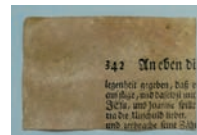
Obr. 9c: Papír vyschl, v jeho strukturu se usadil oxid manganicitý.
