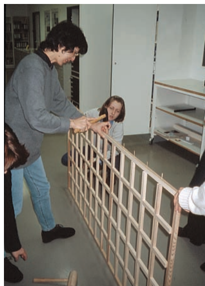
Abb. 6: Einschlagen der Bambusnägel beim Zusammenfügen des Holzgerüsts.
