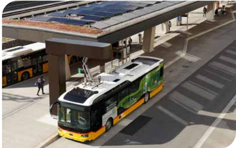
PV-Anlage auf dem Dach des Busbahnhofterminals, Ladestation und E-Bus mit Batterien im Wagendach.
